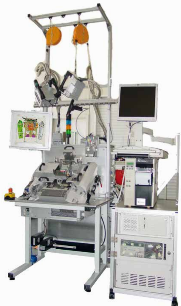
Montage- und Prüfvorrichtung für FDS
