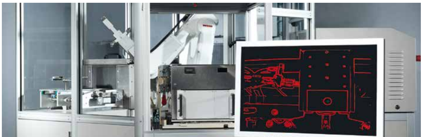
Smart-Kamera-Bildmustererkennung (Mi. o.) eines Positionsmarkers (re.) für die automatische Kalibrierung eines Roboters (Mi.) nach Änderung des Prüfsettings
