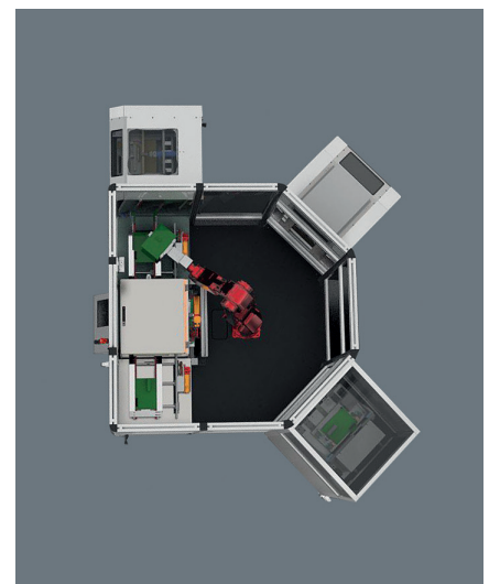
UCMr: Demo-UCM-Roboterzelle mit angedockten UCMi und UCMB für PCB (li. U. & o.) sowie UCMB für EAS (re.o.) und Heizstrecke mit Ofen (u. innen)
